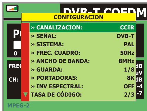
Figura 19.- Pantalla de configuración de medida de señales moduladas en COFDM.
