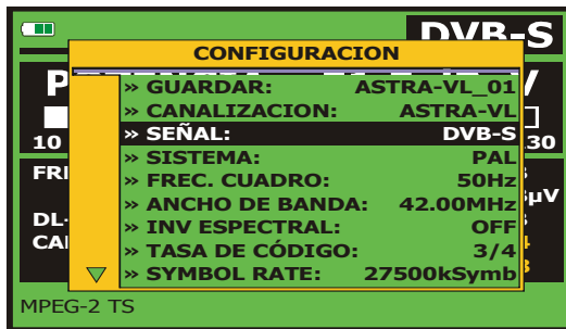
Figura 22.- Pantalla de configuración de medida de señales moduladas en QPSK .
