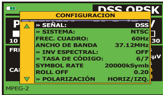
Figura 23.- Pantalla de configuración de medida de señales DSS .
