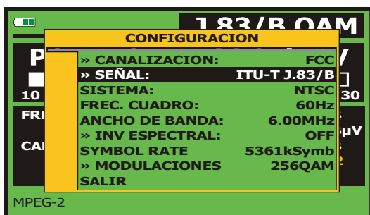
Figura 20.- Pantalla de configuración de medida de señales moduladas en QAM Annex-B.
