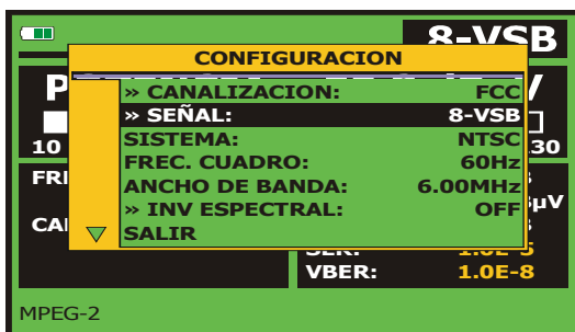
Figura 21.- Pantalla de configuración de medida de señales moduladas en 8-VSB.
