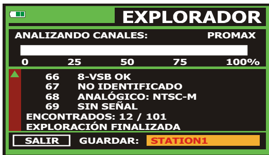
Figura 18.- Pantalla de exploración del espectro. EXPLORER.
