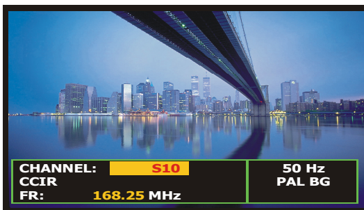
Figura 59.- Visualización de un canal analógico.
