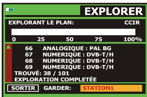
Figure 18.- Écran d'exploration de spectre. EXPLORER.
