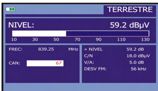
Figura 22.- Medida del nivel de señal analógica en banda terrestre.
