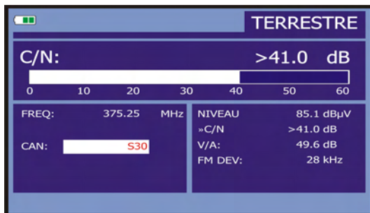
Figure 26.- Mesure du rapport porteuse/bruit (C/N).
