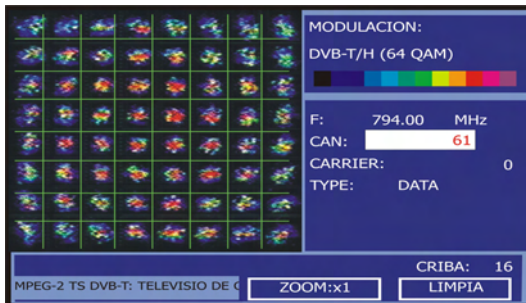
Figura 41.- Diagrama de constelación. Señal DVB-T/H (QAM 64).
