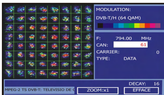
Figure 41.- Diagramme de constellation. Signal DVB-T/H (QAM 64).
