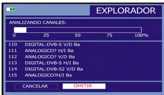
Figura 18.- Pantalla de exploración del espectro. EXPLORER .
