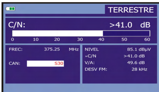
Figura 26.- Medida de la relación portadora/ruido (C/N).
