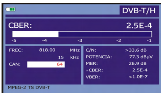
Figura 31.- Pantalla de medida del CBER de señales moduladas en COFDM .
