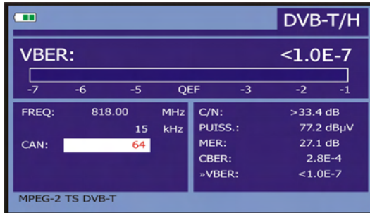
Figure 33.- Écran de mesure du BER de signaux modulés en COFDM. VBER.
