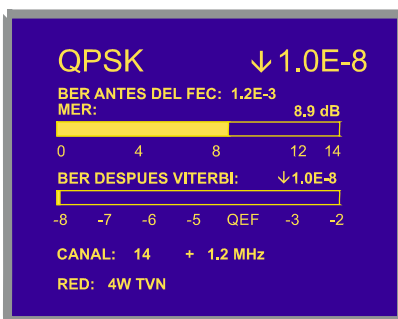
Figura 21.- Pantalla de medida del MER de señales moduladas en QPSK.
