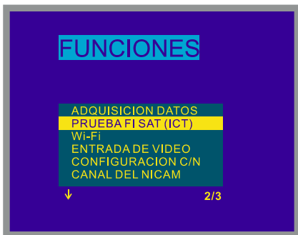
Figura 49.- Selección de la Prueba FI Sat, (banda satélite, canales analógicos).
