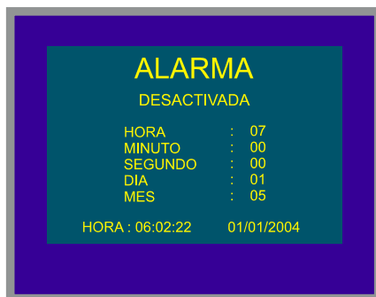
Figura 47.- Definición de la hora de inicio de adquisición de medidas.
